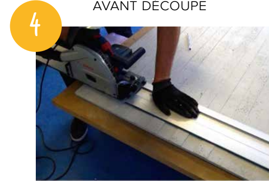
DÉCOUPER À L'AIDE D'UN RAIL DE GUIDAGE
